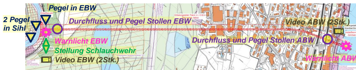
Abbildung 6.2: Instrumentierung des Entlastungsstollens und Lage der Messstellen im Nahbereich.
