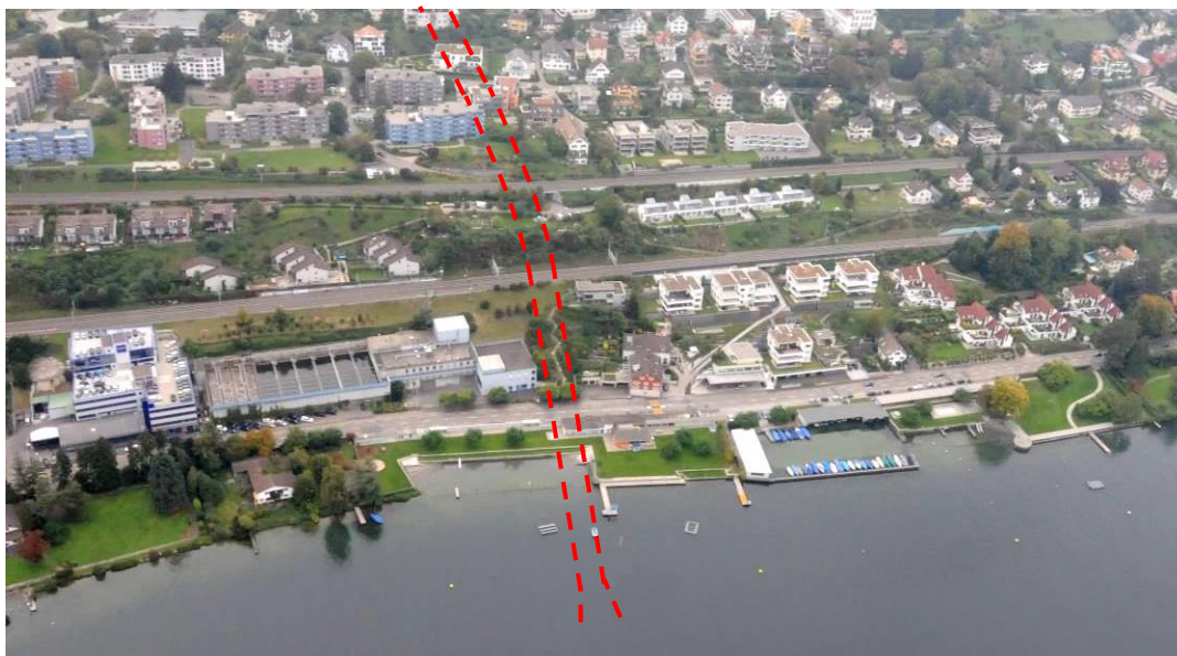
Abbildung 4.17: Schematische Linienführung Entlastungstollen und Auslaufbauwerk in den Zürichsee
